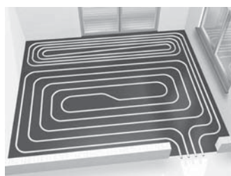
zone périphérique / de vie deux circuits séparés
