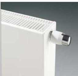
L'E.Flow Parada est un radiateur avec une face avant plane, à robinetterie intégrée, possédant 8 connexions, dont deux au centre. En cas de branchement central, l'écoulement de l'eau à l'intérieur du radiateur se fait de manière diagonale. L'E.Flow Parada offre ainsi non seulement une flexibilité maximale, mais également un rendement thermique optimal garanti.
