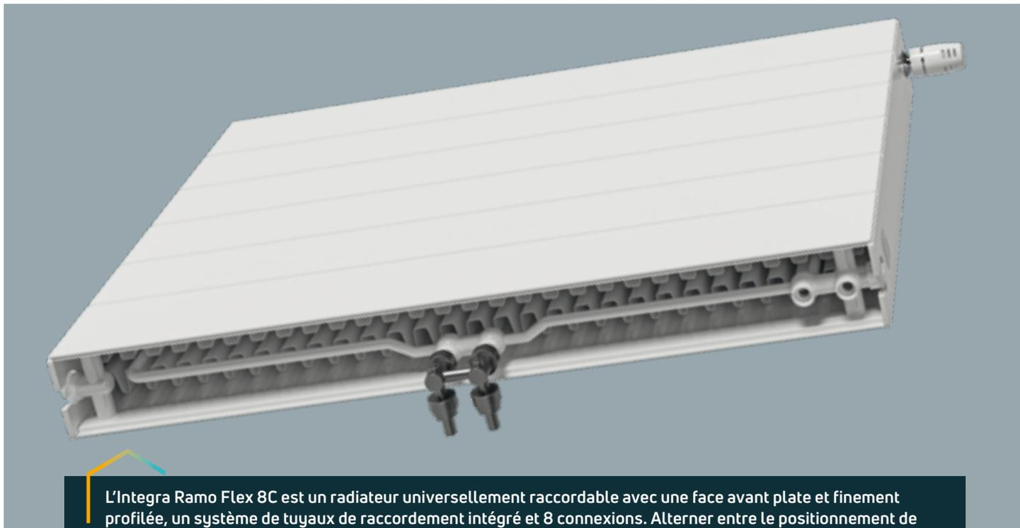
L'Integra Ramo Flex 8C est un radiateur universellement raccordable avec une face avant plate et finement profilée, un système de tuyaux de raccordement intégré et 8 connexions. Alternier entre le positionnement de l'insert thermostatique à droite ou à gauche en haut du radiateur est facile grâce au choix entre l'alimentation en partie centrale ou à droite en dessous du radiateur.
