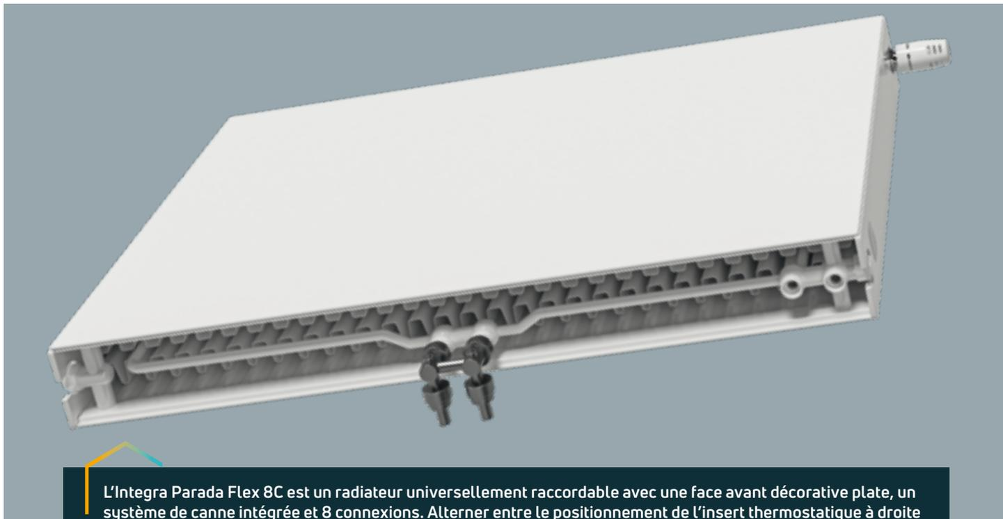
L'Integra Parada Flex 8C est un radiateur universellement raccordable avec une face avant décorative plate, un système de canne intégrée et 8 connexions. Alternier entre le positionnement de l'insert thermostatique à droite ou à gauche en haut du radiateur est facile grâce au choix entre l'alimentation en partie centrale ou à droite en dessous du radiateur.
