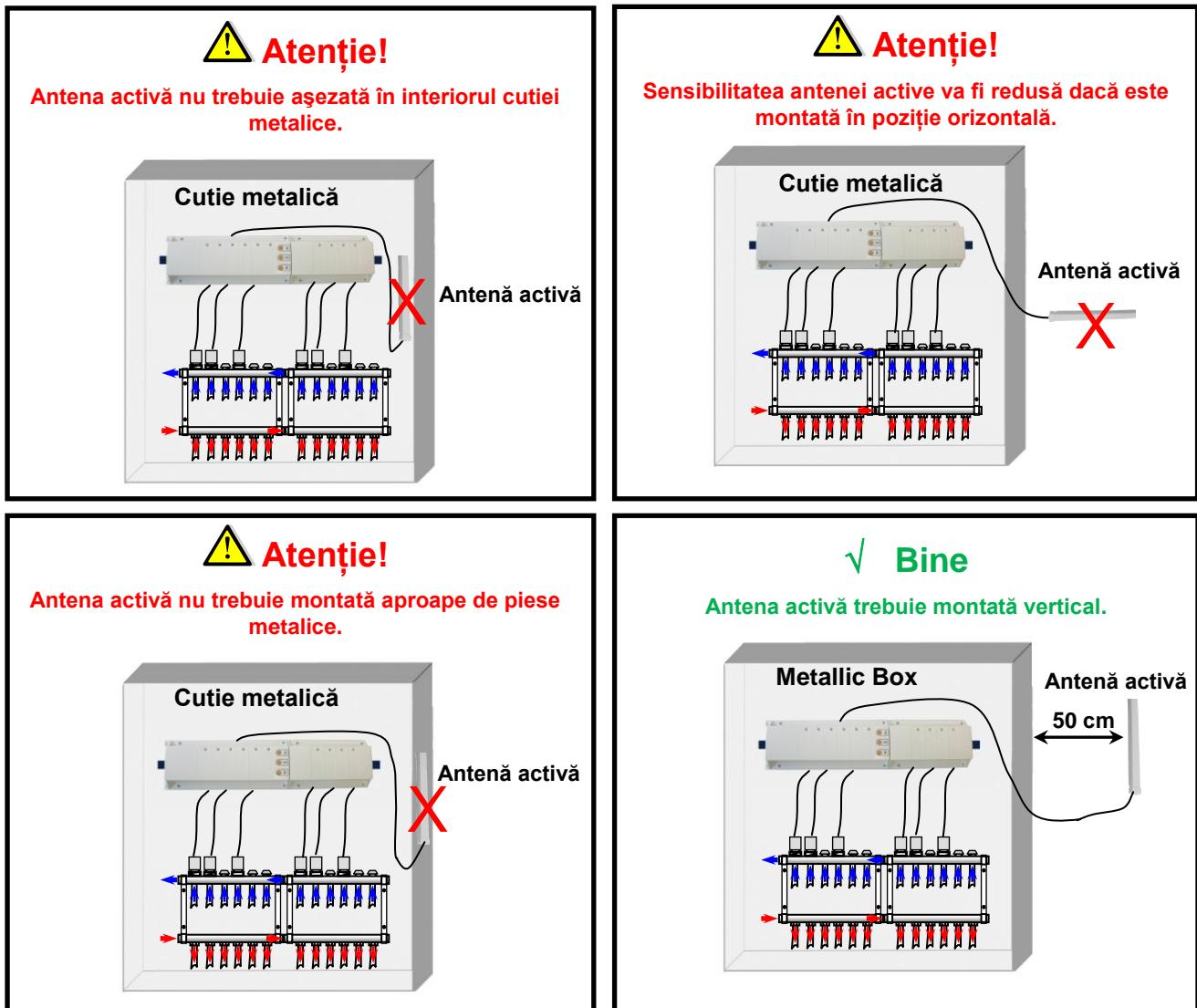
\* Pentru o sensibilitate radio maximă, antena activă trebuie așezată la cel puțin 0,50 cm de suprafețele metalice (Cutia electrică) sau conducte metalice verticale.
