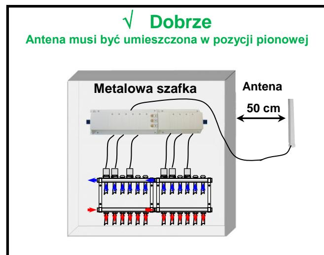
\* Aby osiągnąć największy stopień czułości anteny należy umieścić ją min. 50cm od jakiejkolwiek metalowej powierzchni lub metalowych pionowych rurociągów.
