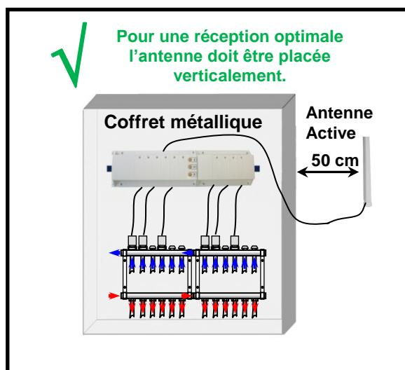
\* Pour une réception optimale l'antenne RF doit être placée verticalement et à une distance minimale de 50cm de toutes parties métallique (Tuyauterie, chemin de câbles électriques, armoire...).
