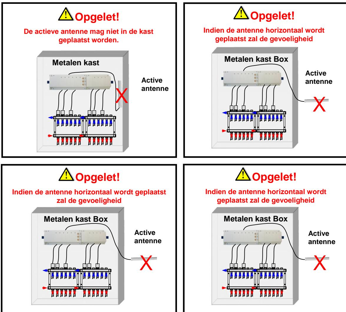
\* Voor een maximale ontvangst moet de antenne minimum 50 cm van een metalen kast of verticale leidingen verwijderd worden.
