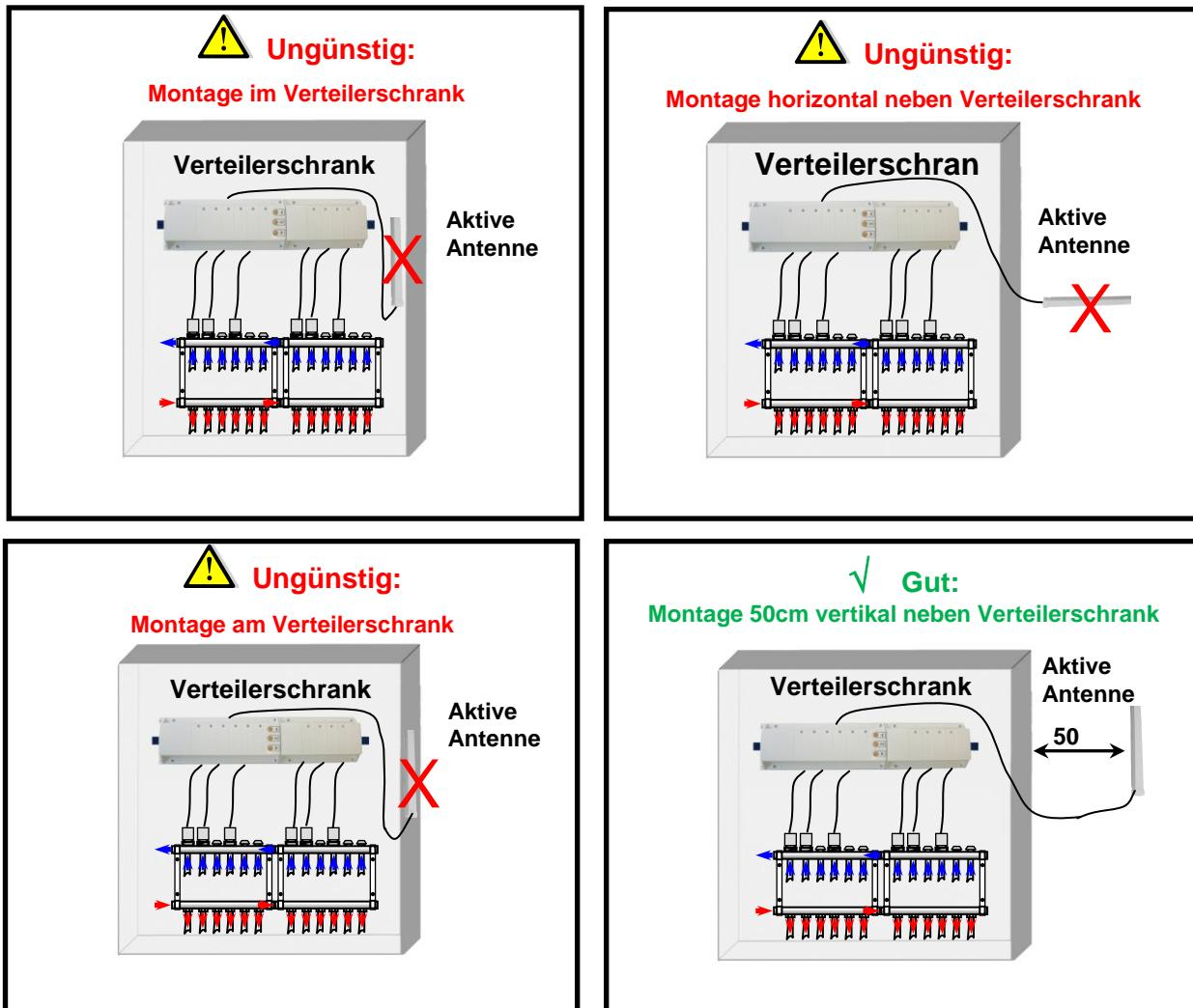
\* Für eine maximale Empfangsleistung und bei schwierigen Bedingungen sollte die Antenne in mindestens 50 cm Entfernung zum Verteilerschrank installiert werden.
