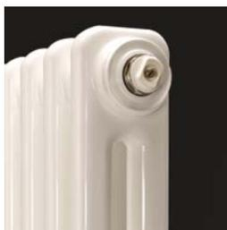
Radiateurs tubulaires en acier complètement soudés au laser. Les profilés tubulaires et collecteurs sont soudés au laser pour former des colonnes et des blocs. Les tuyaux sont aplatis pour obtenir le "profil tubulaire en D" typiquement Delta. Cela se traduit par une émission calorifique accrue. La soudure au laser produit des soudures pratiquement invisibles.
