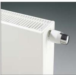
L'E.Flow Parada est un radiateur avec une face avant plane, à robinetterie intégrée, possédant 8 connexions, dont deux au centre. En cas de branchement central, l'écoulement de l'eau à l'intérieur du radiateur se fait de manière diagonale. L'E.Flow Parada offre ainsi non seulement une flexibilité maximale, mais également un rendement thermique optimal garanti.
