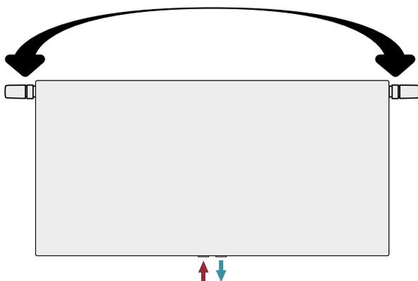
Le changement facile du côté de fonctionnement de la tête thermostatique en changeant simplement l'insert de vanne de la position standard droite à la position gauche est particulièrement notable.
