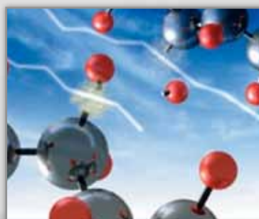
Figure 2. Des faisceaux d'électrons ciblés éjectent des atomes uniques d'hydrogène de la chaîne, laissant les atomes « non appariés » d'hydrogène au sein de la chaîne. L'hydrogène non apparié dans une chaîne « fait équipe » et part. Les carbones libres s'assemblent et forment un pont – le « cross-link » (réticulation).
